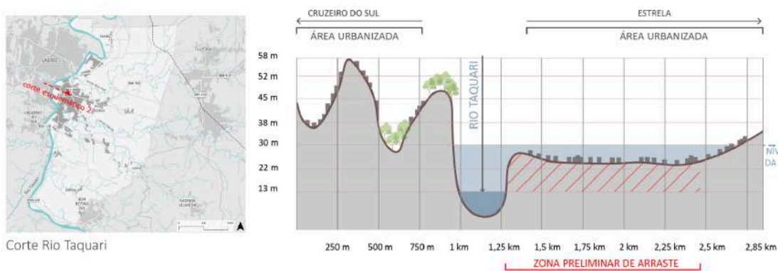
Figura 34: Corte esquemático de situação de inundação em área urbana de Estrela em maio de 2024.
